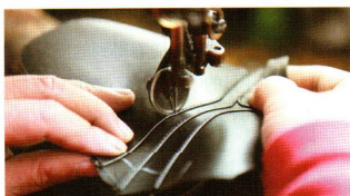
剪裁過後的皮面，先在縫合處打薄，再進行縫製。
